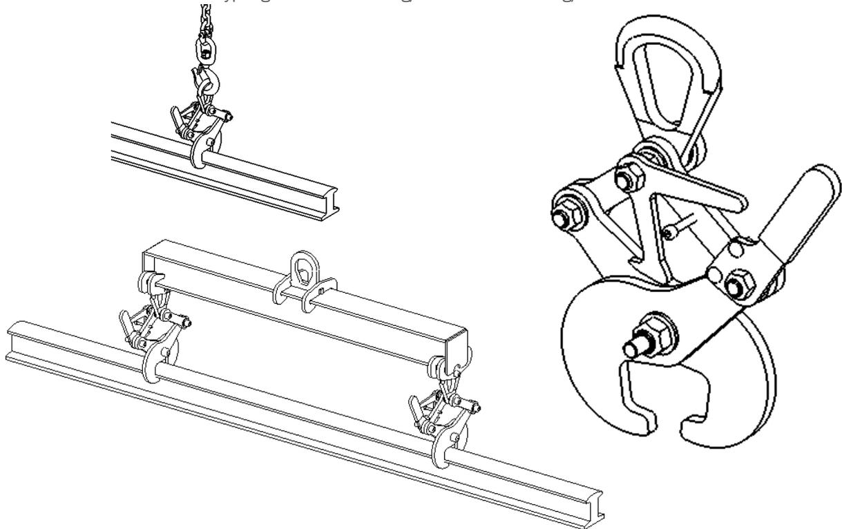
Der Greifer PR ist mit einem Verriegelungssystem ausgestattet: die Last wird ohne menschlicher Eingriff niedergelegt.
